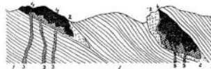
Сл. 133. Схематични пресек ради објашњења двају главних могућности метасоматског постанка гвоздене руде из кречњака.
