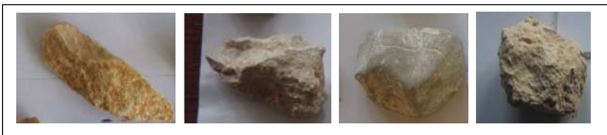
Tablica 3.1: Određivanje oblika zrna prema Zinggu
