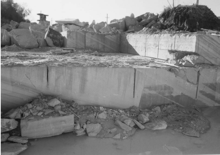
Sl. 2. Eksploataciona etaža na ležištu kamena (svijetlo - tenelija) za obnovu Starog Mosta
