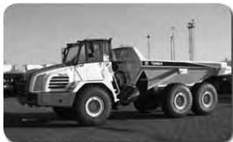
TA25 - zglobni damper nosivost: 25t; težina stroja: 21.205 kg kapacitet sanduka: 13,5 m 3 motor: Cummins, QSC8.3 224kW/300KS max. brzina: 50,4km/h
