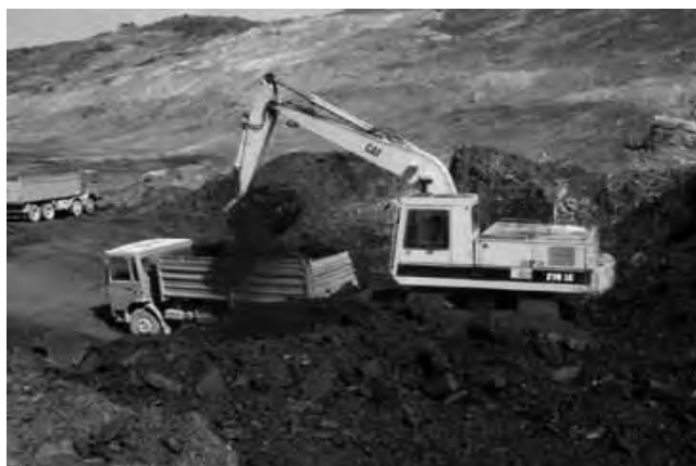
Slika 1. Kompleks bager – kamion koji je radio na doeksploataciji revira „Odžak“ Banovići
