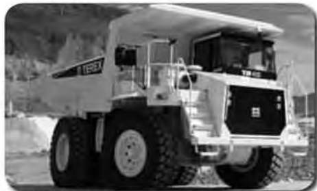
TR45 - kruti damper nosivost: 45t; težina stroja: 37.135 kg kapacitet sanduka: 26 m 3 motor: Cummins, QSK19 392kW/525KS max. brzina: 65,0km/h
