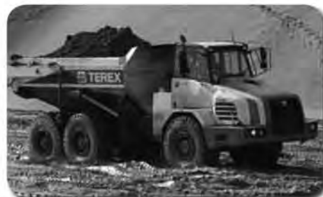
TA30 - zglobni damper nosivost: 30t; težina stroja: 22.485 kg kapacitet sanduka: 17,5 m 3 motor: Cummins, QSM11 287kW/385KS max. brzina: 50,4km/h
