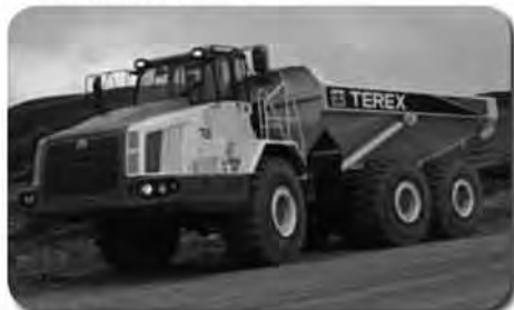
TA35 - zglobni damper nosivost: 35t; težina stroja: 30.370 kg kapacitet sanduka: 21,0 m 3 motor: Detroit Diesel Ser.60 298kW/400KS max. brzina: 53,9km/h
