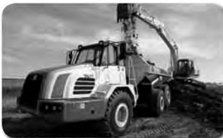
TA27 - zglobni damper nosivost: 27t; težina stroja: 22.205 kg kapacitet sanduka: 15,5 m 3 motor: Cummins, QSM11 272kW/365KS max. brzina: 50,4km/h
