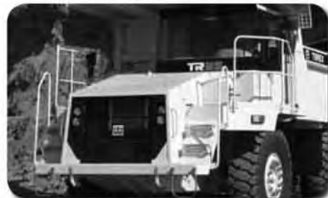
TR35 - kruti damper nosivost: 35t; težina stroja: 23.660 kg kapacitet sanduka: 19,4 m 3 motor: Cummins, QSM11 298kW/400KS max. brzina: 59,0km/h
