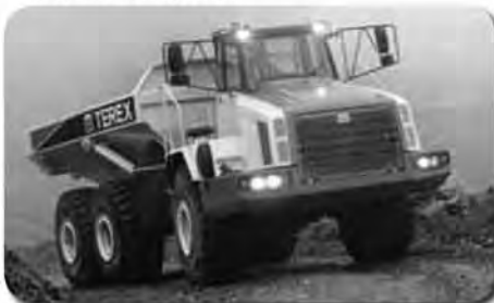
TA40 - zglobni damper nosivost: 40t; težina stroja: 30.820 kg kapacitet sanduka: 23,3 m 3 motor: Detroit Diesel Ser.60 336kW/450KS max. brzina: 60,0km/h
