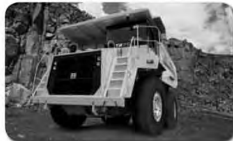
TR70 - kruti damper nosivost: 70t; težina stroja: 47.690 kg kapacitet sanduka: 41,5 m 3 motor: Detroit Diesel MTU-2000TA 567kW/760KS max. brzina: 57,0km/h
