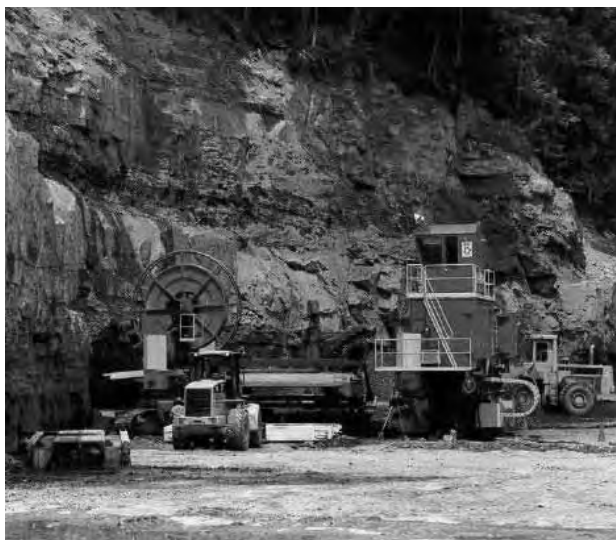
Slika 5. HWM u radu – bubanj sa nomotanim kablom na lijevoj strani mašine
